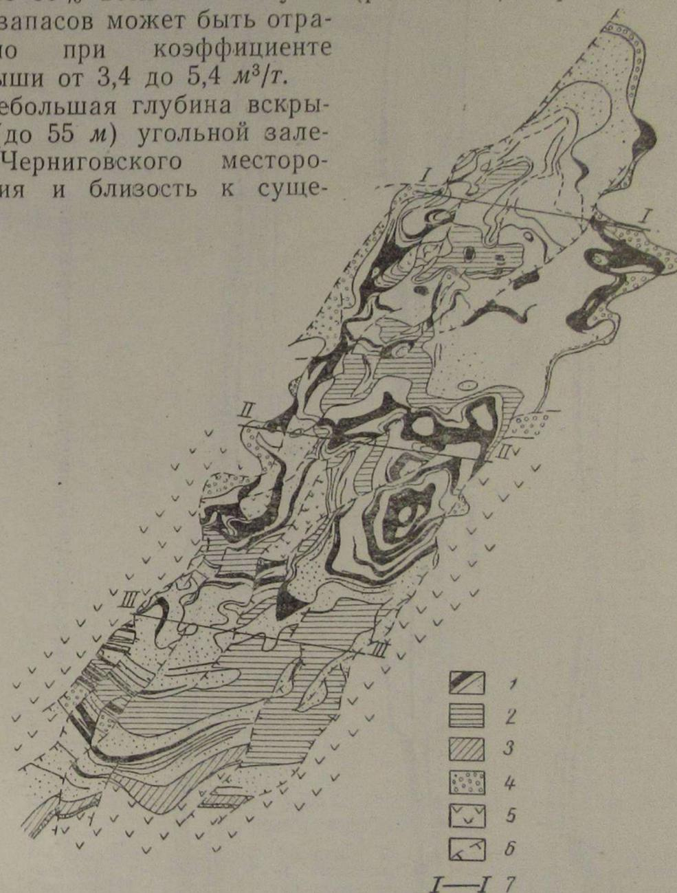
Рис. 2. План вывода рабочих пластов под наносы на Кушмурунском месторождении.
