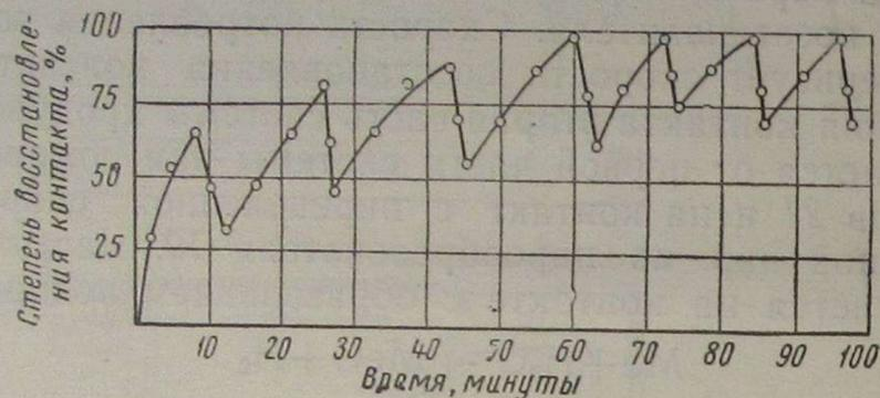
Рис. 2. Изменение степени восстановления контакта со временем при его попеременном восстановлении и окислении ( $t = 450^\circ$ ).
