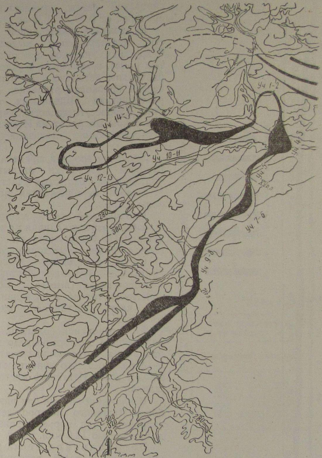
Рис. 6. План выхода рабочего пласта под наносы на Итатском месторождении.
